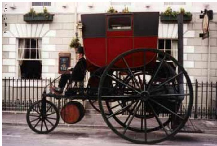
Die Trevithick London Coach Engine von 1802 hatte bereits grosse und schmale Räder, um den Rollwiderstand zu minimieren.
